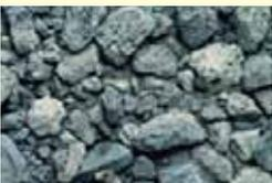
焼却灰に含まれる重金属類は蒸発抽出し、ダイオキシン類は高温分解除去できますので、溶融還元石は環境に対して極めて安全なリサイクル資材として社会へ提供することができます。また、JIS規格に沿った土壌環境基準に基づく溶出量検査と含有量検査を行い、環境安全性を確認しています。
